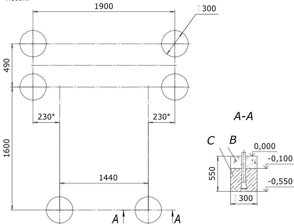
Для исключения люфтов при занятиях на комплексе рекомендуется при монтаже максимально распереть стойки лестниц, зафиксировать их в таком положении при помощи подручного материала (кирпичи, доски и т.п.), после этого забетонировать.
