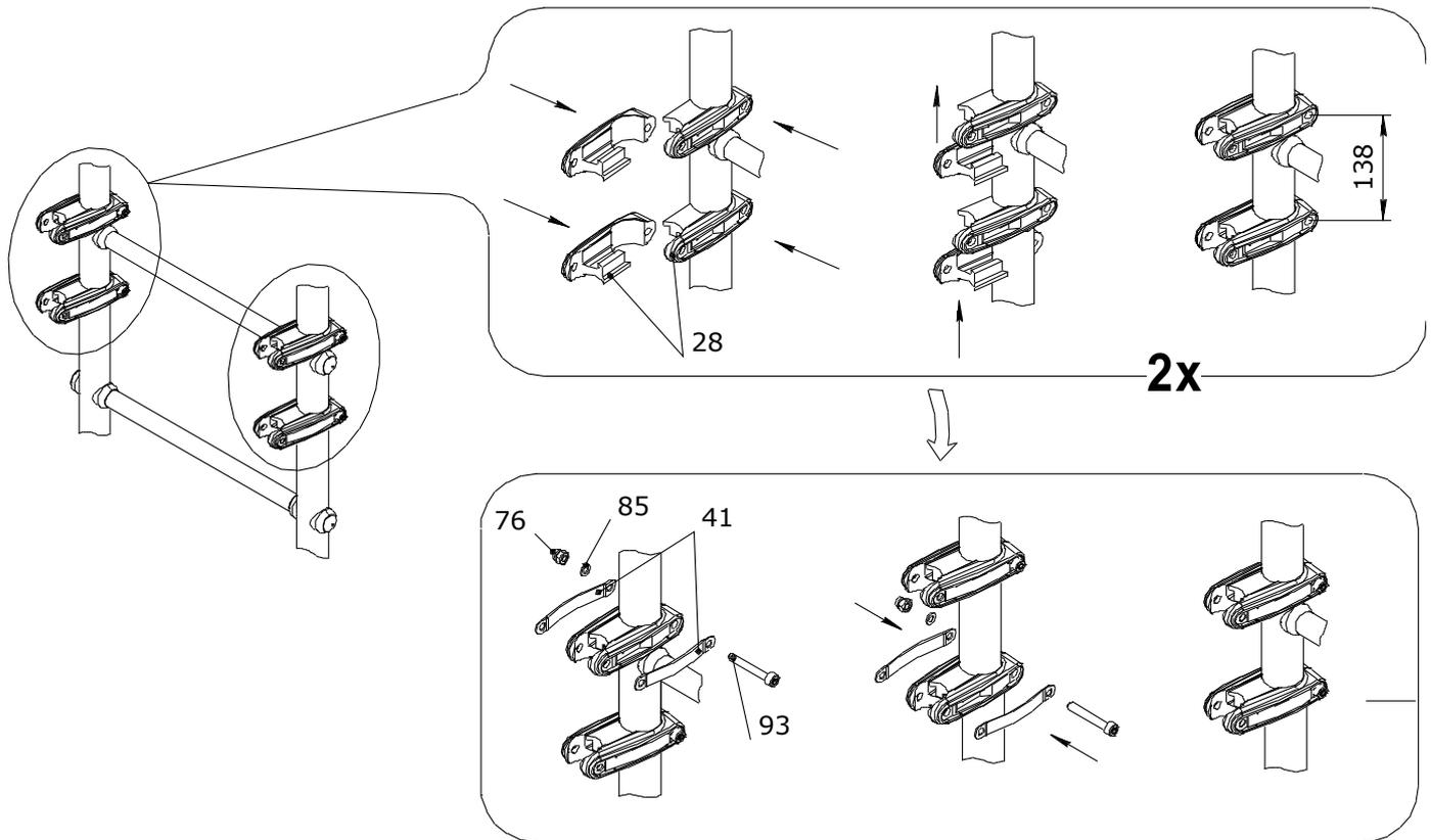
Винты поз.93 с гайками поз.76 предварительно наживить, при этом шайбы поз.85 не использовать.
