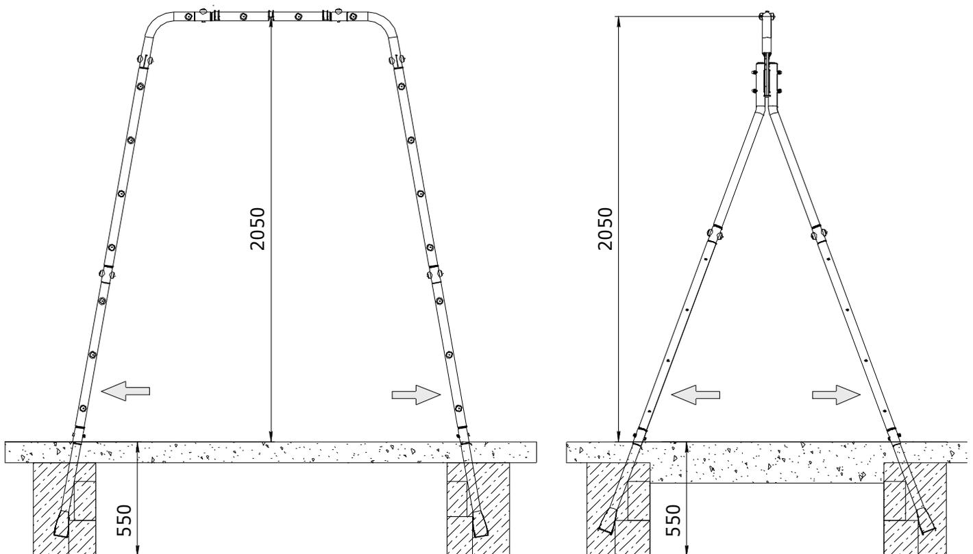
Эксплуатация комплекса допускается только после полного застывания бетона. Бетон необходимо закрыть синтетическим покрытием (резина) или дёрном. Навесное оборудование установить после полного застывания бетона.
