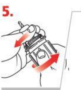
**4.** Затяните патрон, повернув его ручку по часовой стрелке. Зажав сверло, позвольте ему, тем не менее, немного скользить в патроне взад-вперед. Патрон не должен быть полностью затянут, до тех пор, пока мы точно не установим величину выступания сверла из патрона на следующем этапе. Вращайте сверло в патроне, чтобы передняя кромка канавки сверла оказалась напротив зажима (пластины для выравнивания). Это необходимо, чтобы выровнять сверло для правильной заточки.
