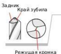
Поверхность от режущей кромки вниз по наклону до самой нижней точки хорошо шлифованная без углублений и других изъянов. Режущая кромка всегда выше нижней точки наклона. Поперечная кромка четкая и прямая.
