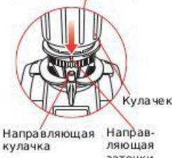
продолжают быть параллельными меткам заточки сверл по бетону на патроне. Затяните патрон и продолжите заточку.
