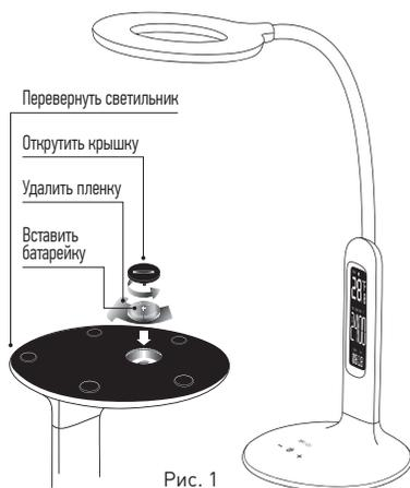
На основании светильника расположены четыре сенсорные кнопки, предназначенные для управления светильником и настройкой часов, календаря и будильника.
