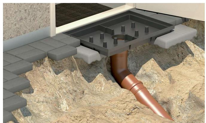
4. В случае установки поддона с использованием канализации — подключить снизу трубу диаметром 110 мм и установить поддон на бетонное основание.
