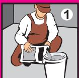
Для приготовления раствора залейте водопроводную воду комнатной температуры в чистую ёмкость из расчёта 0,5 л на 1 кг сухой смеси (на 1 мешок 5 кг – 2,5 л воды).
