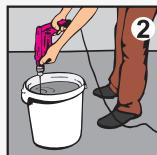
Перемешивайте раствор дрелью со специальной насадкой на низких оборотах, засыпая сухую смесь в воду до получения однородной пастообразной массы. Приготовленную смесь используйте сразу после перемешивания (в течение 6 - 7 минут).
