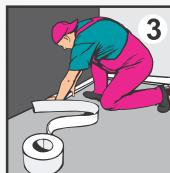
3 Для получения аккуратного шва рекомендуется защищать лицевые кромки конструкций малярным скотчем. Для формирования глубины нанесения герметика шов уплотняется эластичным жгутом из вспененного полиэтилена. Жгут помещают в шов таким образом, чтобы обеспечить соотношение глубина шва/ширина шва = 1/3 или 1/4, но не менее 3 мм, для швов шириной до 15 мм. На более широких швах толщина нанесения герметика должна быть не менее 5 мм.
