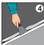
4 При работе в зимнее время рекомендуется выдерживать герметик в отапливаемом помещении не менее суток перед применением. Герметик наносят на подготовленную поверхность при помощи металлического шпателя или шприцевых приспособлений. Для предотвращения прилипания герметика к инструменту используют мыльную воду. При нанесении герметика пустоты и неплотный шов не допустимы.
