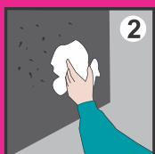
2 Межпанельные швы, стыки и прилегающие к ним поверхности очистить от пыли, грязи, наледи и инея, подсушить ветошью. Сильно впитывающие поверхности загрунтовать грунтом БОЛАРС «Глубокого проникновения».
