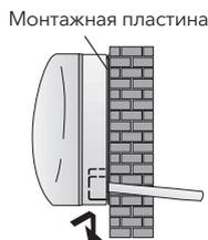
После монтажа труб, произведенного в соответствии с инструкцией, проложите межблочный кабель. Затем проложите дренажный шланг. Обмотайте трассу (медные трубы, дренажный шланг, межблочный кабель) защитной тефлоновой лентой.
