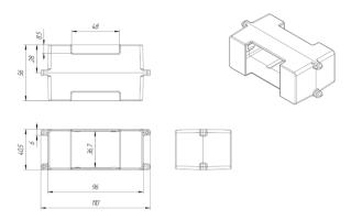
b) Бокс-пломбиратор вводного автомата на DIN-рейку 3 модуля IP20 ЭРА SIMPLE BP-3
