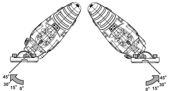
5. Вновь сдвиньте опорную пластину вперед до зацепления.
