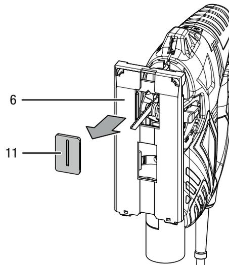
3. Для того чтобы вновь вставить противоскольную пластину (11), осторожно вдавите ее снизу в выемку на опорной пластине до фиксации. При этом проследите за тем, чтобы гладкая сторона противоскольной пластины была направлена в сторону от устройства.
