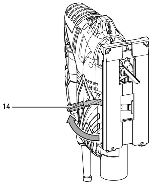
3. Сдвиньте опорную пластину назад, так чтобы она свободно поворачивалась.
