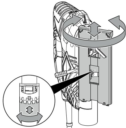
4. Настройте нужный угол резания. Настраиваемое число градусов выгравировано на опорной пластине.
