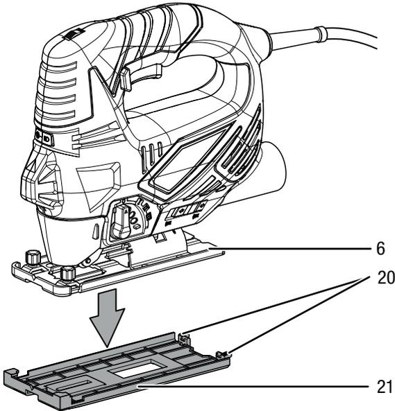
4. Для того чтобы вновь закрепить скользящий башмак (21), сначала наденьте его спереди на опорную пластину (6).
