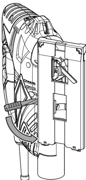
7. Проверьте прочность крепления опорной пластины.
