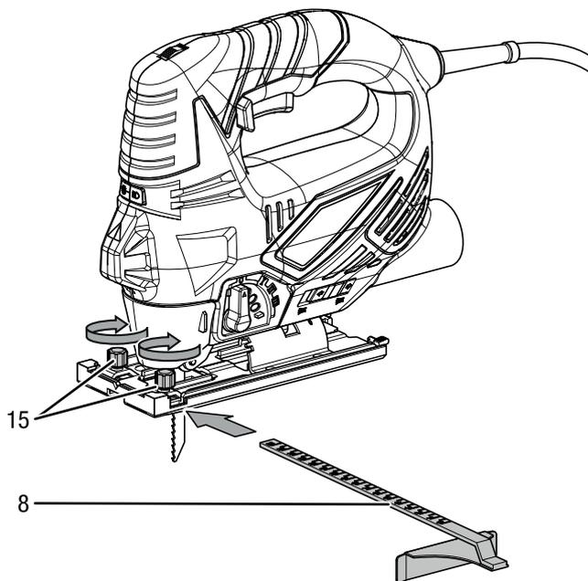
2. Вставьте параллельный упор (8) маркировкой вверх в гнездо.
