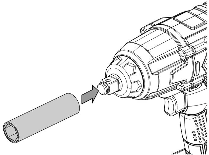
4. Проверьте прочность крепления торцовой головки (9).
