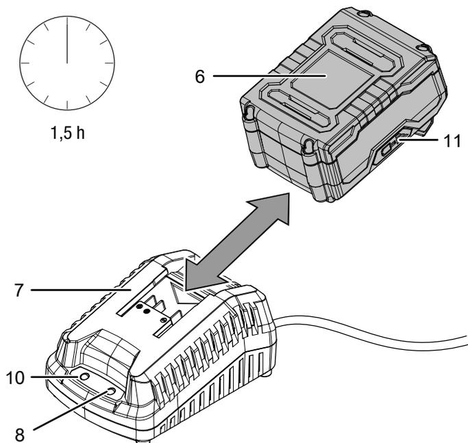
4. Выньте сетевой кабель быстрозарядного устройства (7) из сетевой розетки, взявшись за вилку.
