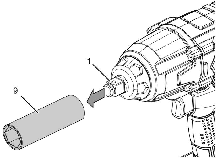
3. Наденьте подходящую торцовую головку (9) на зажим для инструмента (1), так чтобы она зафиксировалась.
