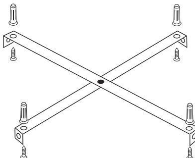
1. Для монтажа светильника необходимо взять крепежную планку светильника, приложить ее к подготовленному месту установки и карандашом разметить места под крепежные метизы.
