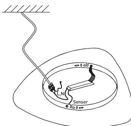
4. Через клеммную колодку подключить сначала контакт заземления (желто-зеленый), нейтраль и фазу.
