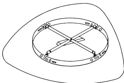
5. Установить светильник совмещая винты с пазами на основании светильника.
