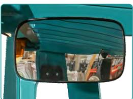
**Панорамное зеркало** служит для контроля слепых зон, улучшает безопасность при работе с грузами
