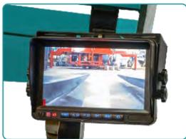
**Видеокамера на вилах в базовой комплектации** обеспечивает максимально точное позиционирование груза. Изображение выводится на цветной экран
