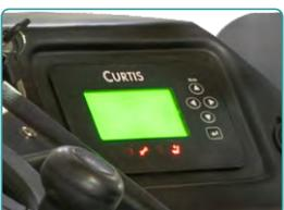
**Многофункциональный LED - дисплей** отображает информацию о наработанных моточасах, уровне заряда батареи, положении рулевого колеса, ошибках в системе
