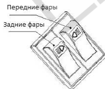
Рисунок 18. Кнопки включения/выключения фар
