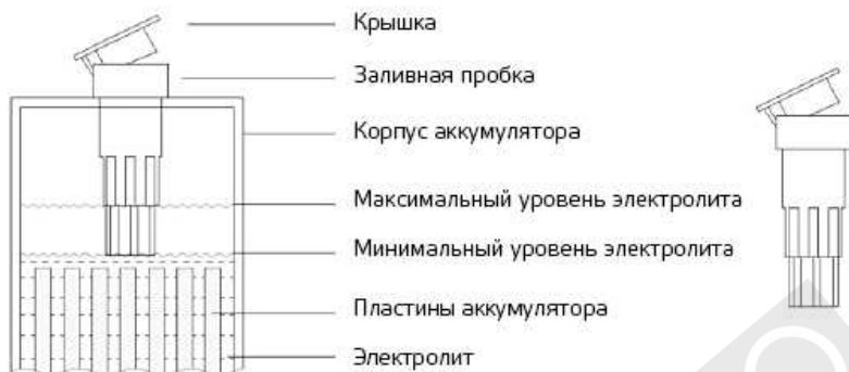
Рисунок 35. Проверка уровня электролита в аккумуляторе ричтрака
