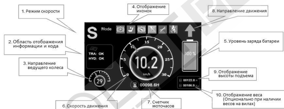
Рисунок 36. Индикатор заряда батареи на дисплее ричтрака
