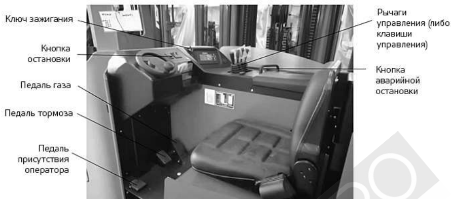
Рисунок 10. Основные устройства управления в кабине оператора
