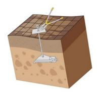
При помощи пресс-клещей зажать стопорный элемент на тросе, далее при помощи тросореза откусить лишний трос с петлёй.
