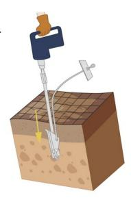
После укладки сетки анкер устанавливается с помощью кувалды (или небольшого отбойного молотка) и толкателя, погружается на всю длину троса, петли остаются на поверхности.
