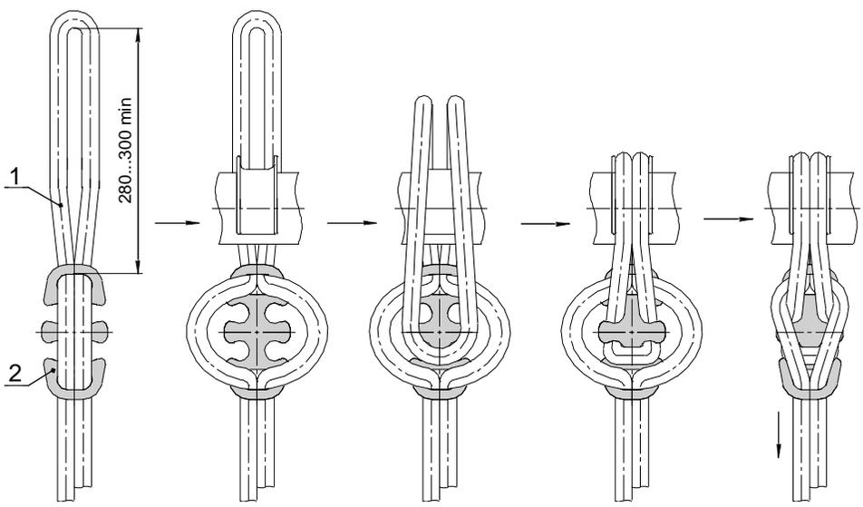
Рис.2. Схема безузлового крепления фиксатора на шнуре
