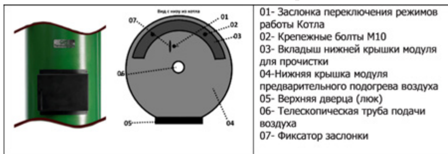
Рис. 31 Съемные элементы котла при чистке котла нижним способом
