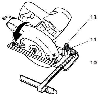
6.4.2 Поворачивая опорную подошву (10), установите необходимый угол пропила от 0° до 45°, руководствуясь шкалой (13).
