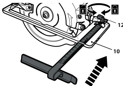
6.2.2 Установите параллельный упор в соответствующие пазы на опорной подошве (10) и отрегулируйте его положение, установив желаемую ширину распила. Затяните вин фиксации.
