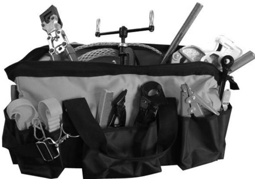
Рис.1. Набор инструментов для монтажника СИП ВК-1
