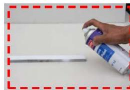
2. Распылите тонким слоем MP-35 на поверхность
