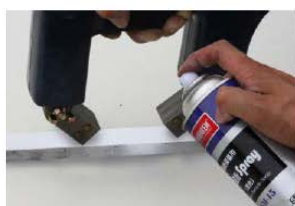
3. Проведите намагничивание поверхности
