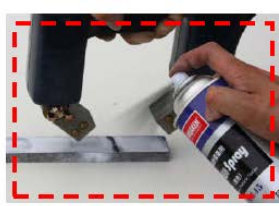
4. Нанесите черную магнитную суспензию SM-15
