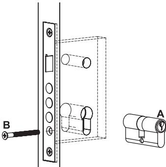
4. Поместите квадрат в корпус замка и наденьте на него ручки. Разместите отверстия под стяжные винты. Снимите ручки и сделайте отверстия в дверном полотне . После установите ручки на квадрат и скрепите их при помощи стяжных винтов. **ВАЖНО!** Шляпки винтов под отвёртку должны быть внутри помещения.
