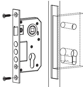
3. Установите цилиндр (A) и зафиксируйте его винтом (B).
