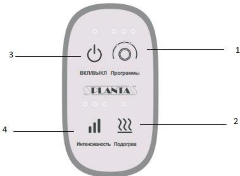
1. Кнопка выбора программы
