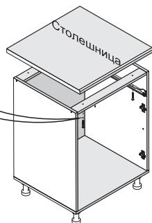
Рекомендуемые размеры свесов столешницы относительно каркаса стола: спереди — 30 мм; сзади — 50 мм.
