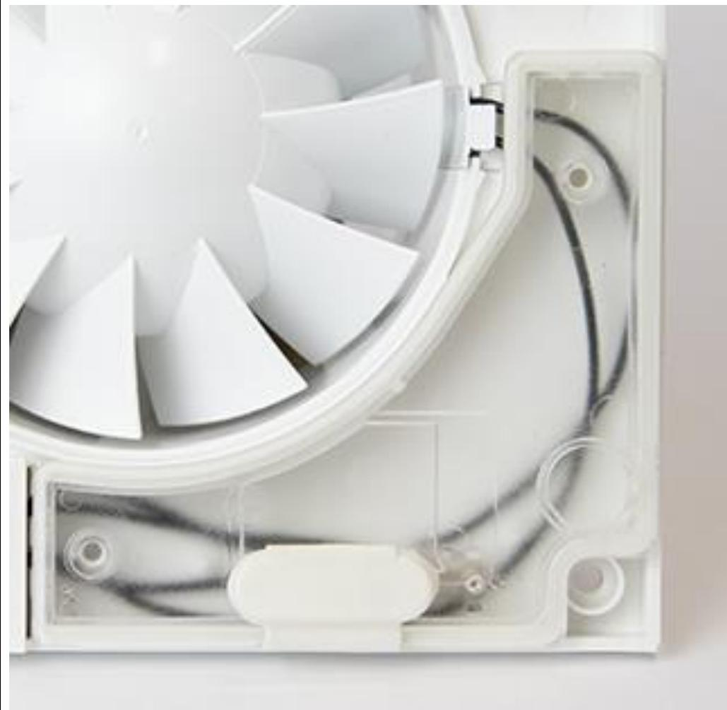
**Подделка:** Отсутствует быстросъемная защитная крышка, вместо этого защитная крышка крепится на шурупах. Уплотнитель и заглушка на защитной крышке сделаны из жесткого пластика. Отсутствует светодиод под защитной крышкой. Провода разных цветов.
