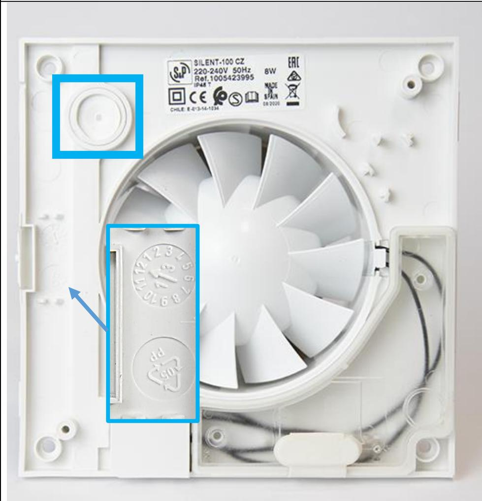
**Подделка:** На корпусе отсутствует маркировка о типе пластика. Имеется множество «заусенцев». Заглушка отверстия сделана из жесткого пластика прозрачного цвета.
