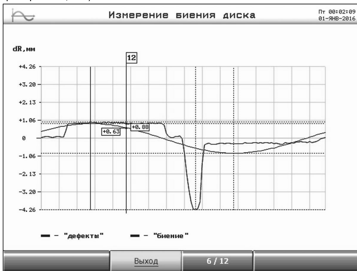
Рисунок 7.6 – Окно измерения биений диска
