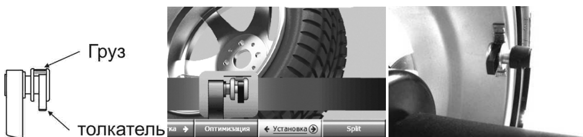
Рисунок 5.13 – Установка груза линейкой
