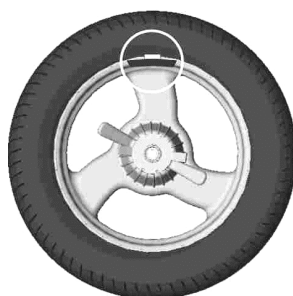
Рисунок 6.6 - Груз установлен в «12 часов»
