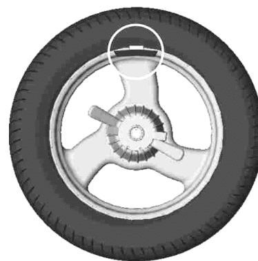
б - груз установлен в положение «12 часов»
