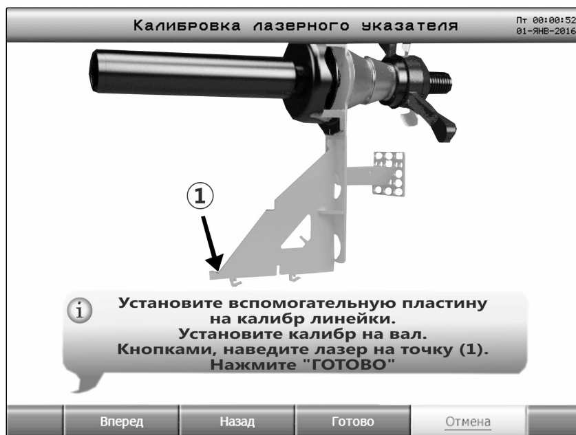
Рисунок 8.7 – Окно калибровки лазерного указателя
