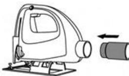
Использование пылеудаления очень практично при последовательной резке, поскольку оно сокращает необходимость прерывания работы для очистки инструмента и рабочей зоны.
