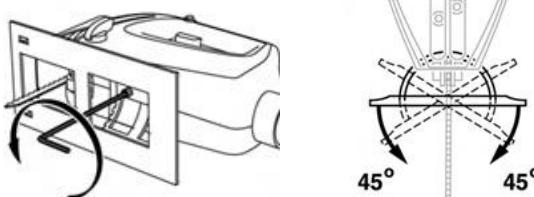
**Помните!** Пиление под углом производится только в прямом направлении. Изменение направления пиления может привести к поломке пильного полотна и, как следствие, к травмам.
