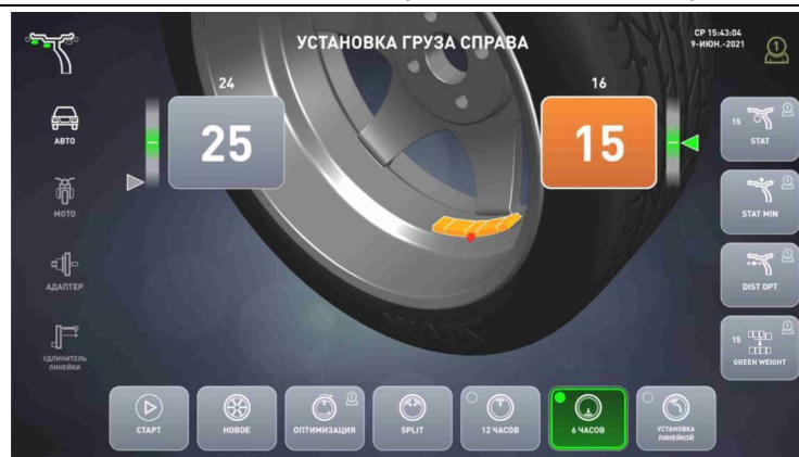
Рисунок 5.8 – Установка в «6 часов» справа
