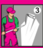
Перед нанесением шпатлевки основания необходимо обработать грунтом БОЛАРС. Марка грунта зависит от вида поверхности.
