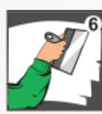
Шпатлевка наносится на основание слоем от 1 до 10 мм, затем выравнивается широким шпателем. Допускается наносить шпатлевку в 2 слоя. Второй слой наносится после полного высыхания первого слоя. Перед нанесением второго слоя поверхность обрабатывается грунтом БОЛАРС.
