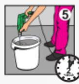
Перемешивание вести механизированным способом, равномерно засыпая сухую смесь в воду до получения однородной пастообразной массы. Раствор необходимо выдержать 3-5 минут, после этого втироично перемешать и он готов к применению. Раствор находится в рабочем состоянии не менее 2-х часов.
