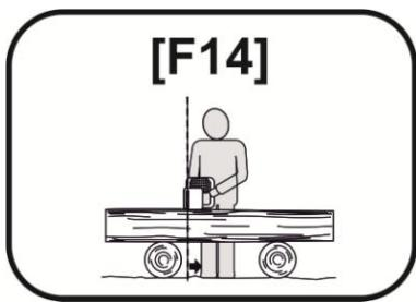
ходе распиловки. Позвольте цепи работать свободно, только слегка применяя давление, используя зубчатый упор (8) как рычаг.
