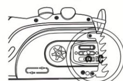
Для проверки натяжения достаточно натянуть пильную цепь (7). Имеющее нормальное натяжение цепь можно натянуть сверху посередине не более чем на 3-4 мм. [см. рис. F6]
