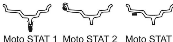
г – статическая балансировка мотоциклетных колес
