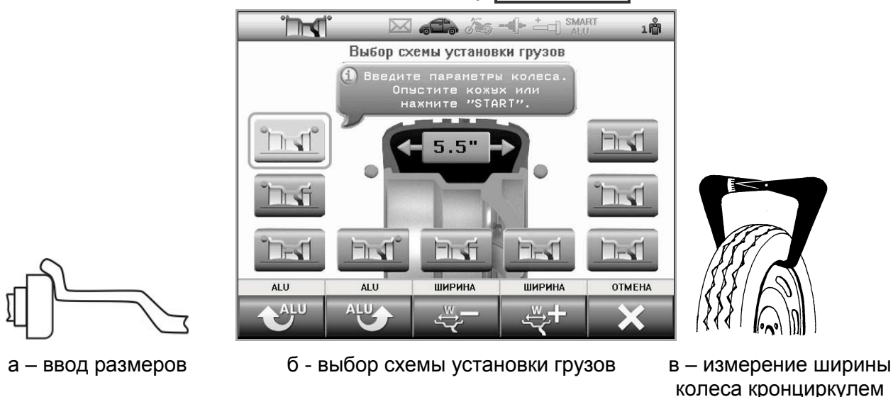
Рисунок 6.2 - Ввод параметров стандартного колеса
