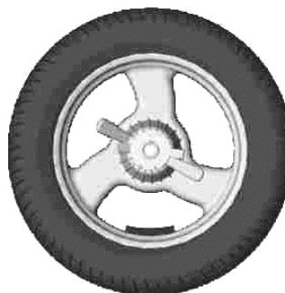
Рисунок 6.11 – Установка ленточных грузов
