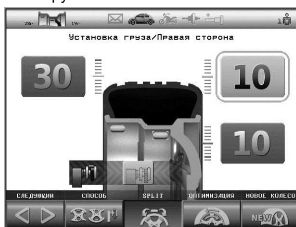
Рисунок 7.5 – Экран установки грузов в режиме Split
