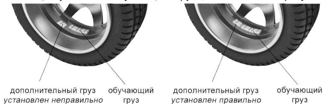
Рисунок 7.2 – Положение дополнительного груза
