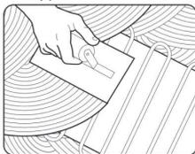
**11. Вновь повторите контрольное измерение сопротивления нагревательного мата и датчика температуры пола после того, как система заделана в слой плиточного клея или выравнивающегося бетона. Уложите напольное покрытие.**
