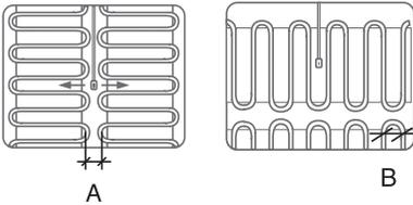
**7. Сделайте контрольное измерение сопротивления нагревательного мата и датчика температуры пола после крепления к основанию пола.**
