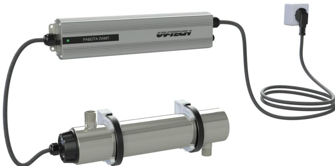
УОВ состоит из камеры обеззараживания, выполненной из нержавеющей стали AISI-304, блока питания с индикацией работы УФ-лампы. Камера соединена безразъёмным кабелем с блоком питания, а от блока проходит безразъёмный кабель подключения системы со штексель вилкой 220В.
