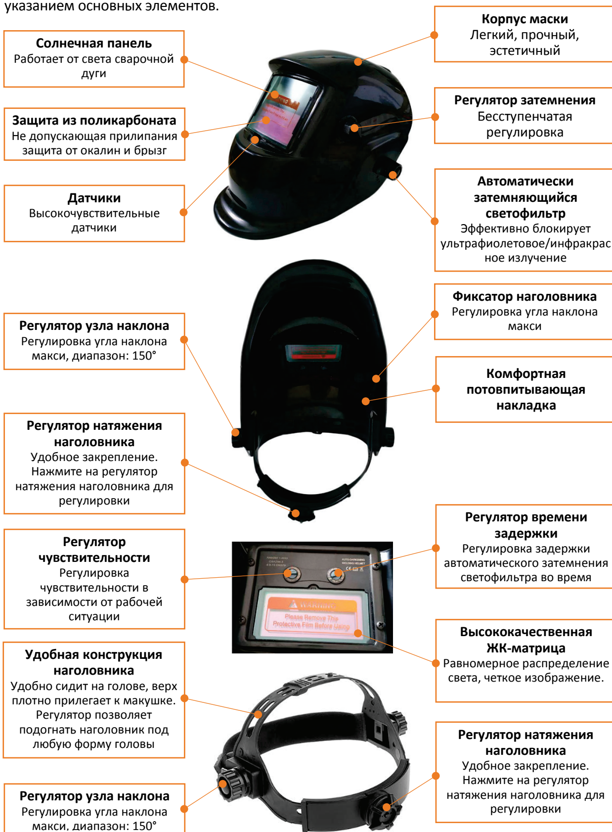
Рис. 1. Сварочная маска с автоматическим затемнением. Основные элементы.
