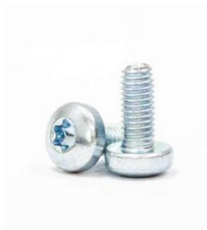
Резьбовыдавливающие винты M5x12 DIN 7500C TX самостоятельно выдавливают резьбу непосредственно в момент своего монтажа. Процесс происходит за счет специальной входной части стержня, при этом металлические стружки не остаются. Винты имеют полукруглую цилиндрическую головку и шлиц TORX. "
