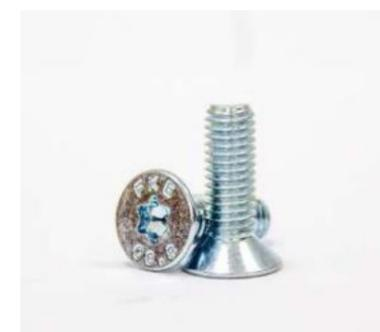
Винт M5x16-8,8 ISO 10642 со шлицем Torx имеет потайную голову. Расчитан на условия высоких нагрузок. Крепежный элемент является высокопрочным, изготавливается с полной резьбой или с неполной.
