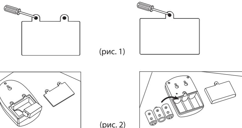
б) Вставьте батарейку 9V типа «Крона» в батарейный отсек датчика и 3 батарейки типа «С» в батарейный отсек приёмника, соблюдая полярность (рис. 2).
