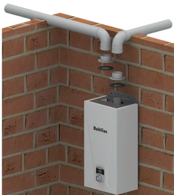
Рис. 8 Схема присоединения отдельного дымохода \varnothing 80 мм к котлу
