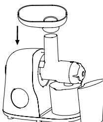
Установите лоток на загрузочную горловину. Не забудьте про толкатель. Проверьте, что переключатель работы установлен в позицию OFF (выключено), и подключите соковыжималку к сети электропитания.
