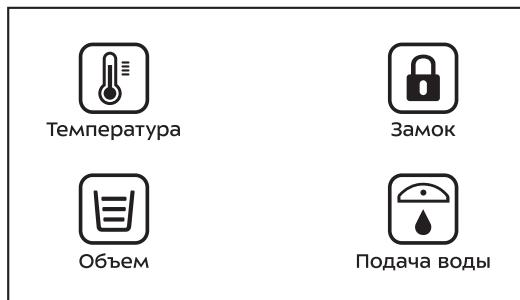
**Температура** — кнопка выбора температуры воды. Доступны следующие значения температуры: 25, 45, 50, 60, 70, 80, 90, 100 °C. При выборе температурного режима 25 °C термопот не нагревает воду, а сохраняет исходную температуру воды.
