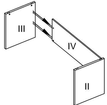
Положить столешницу отверстиями вверх. Забить в столешницу шканты (1) и цанговые футорки (4). Вкрутить в цанговые футорки дюбеля (3) до упора в обод. Присоединить к столешнице каркас и затянуть отверткой стяжки-эксцентрики (2) на боковинах. Закрыть торцы стяжек-эксцентриков декоративными заглушками (8). Поставить стол.
