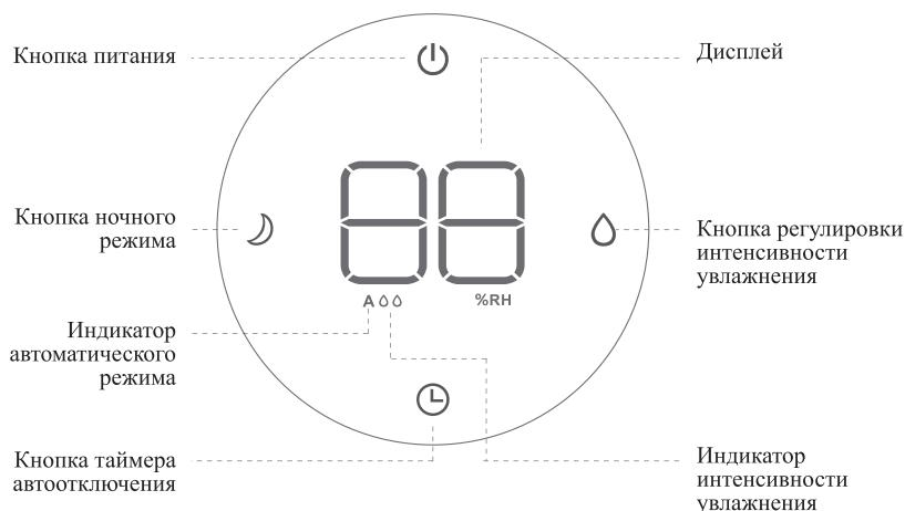
⊕ — кнопка питания. Нажатие на кнопку позволяет включить и выключить устройство. При нажатии на кнопку раздается короткий звуковой сигнал.
