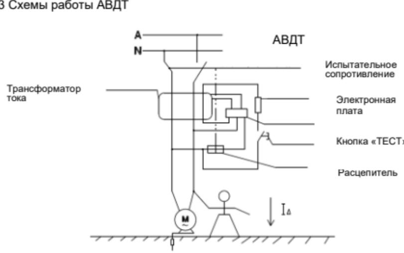
А) Рис. 1. Принцип работы АВДТ 1P+N: два проводника.
