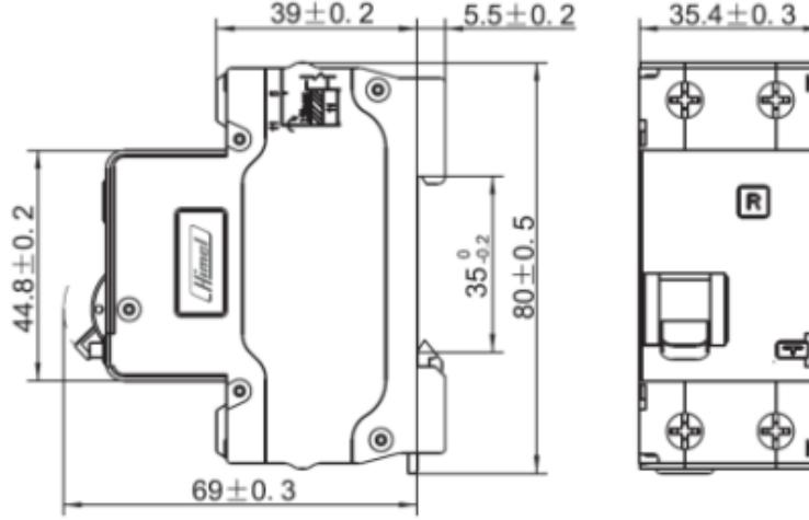
Рис. 4. Установочные и габаритные размеры ДИФ-103 4,5кА
