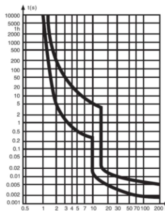
Рис. 3. Время-токовая характеристика D.
