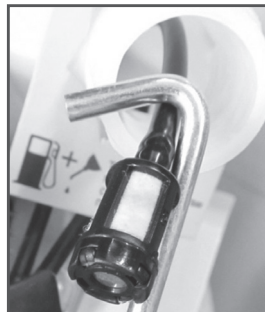
Рис. 12 Извлечение топливного фильтра
