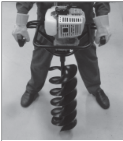
Рис. 8 Положение тела оператора при работе мотобуром
