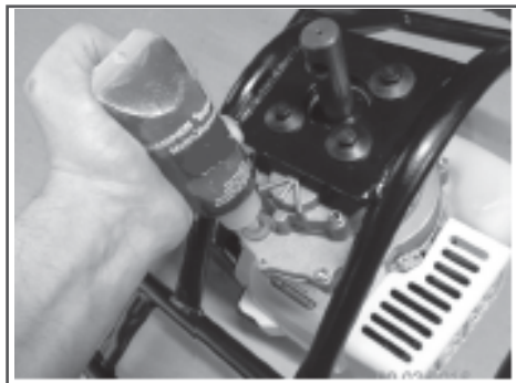
Рис. 15 Добавление смазки в корпус редуктора
