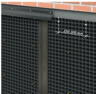
4. Закрепите PLANTER механически выше уровня гидроизоляции с помощью специального крепежа PLANTER fixing и закройте верхний край мембраны декоративной планкой PLANTER profile
