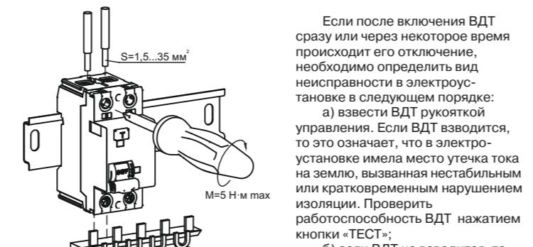
Если после включения ВДТ сразу или через некоторое время происходит его отключение, необходимо определить вид неисправности в электроустановке в следующем порядке:
