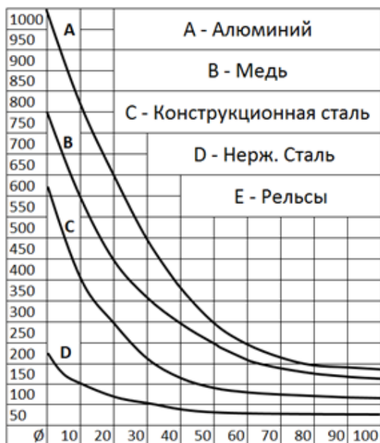
Режимы сверления (об/мин) для HSS сверл
