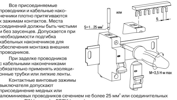
Контактные винтовые зажимы выключателя допускают присоединение медных или алюминиевых проводников сечением не более 25  $\text{мм}^2$  или соединительных шин типов PIN (штырь) и FORK (вилка).
