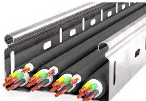
Более толстые кабели должны укладываться в нижней части лотка, чтобы не повредить своим весом более тонкие кабели
