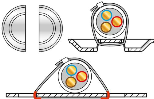
Такое конструктивное решение позволяет крепить кабель к лотку при помощи стяжки. Стяжка протягивается в специальное отверстие, а потом затягивается. Это очень удобно при сложном монтаже, например, когда под лотком уже что-то есть и мешает монтажу или когда лоток смонтирован непосредственно по стене.
