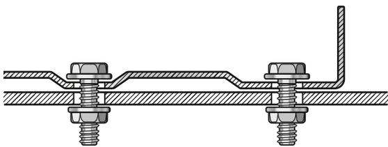
Отбортовка выполнена на монтажных отверстиях. Она не только увеличивает жесткость лотка, но и сохраняет плоскостность (плоскость отверстия совпадает с плоскостью ребра жесткости). При монтаже лотка болтовым соединением он не деформируется.
