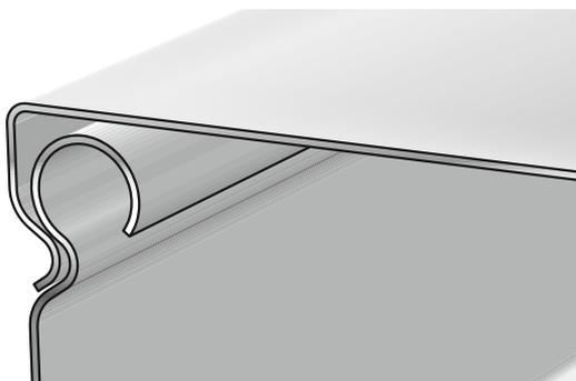
За счет округлого замка на стенке лотка возможность порезать руки или повредить кабель при монтаже снижена к минимуму, в отличие от других лотков на рынке.
