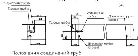
Трубки могут быть присоединены к блоку с 3-х сторон. Когда труба проходит сзади, можно удалить кронштейн, тогда работать с трубами станет легче. После окончания работ с трубами поставьте кронштейн на место.
