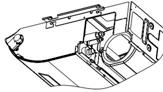
Разрежьте удаленную верхнюю крышку и установите на заднюю панель вместо задней крышки.
