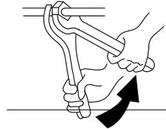
Затяните гайки ключом.
