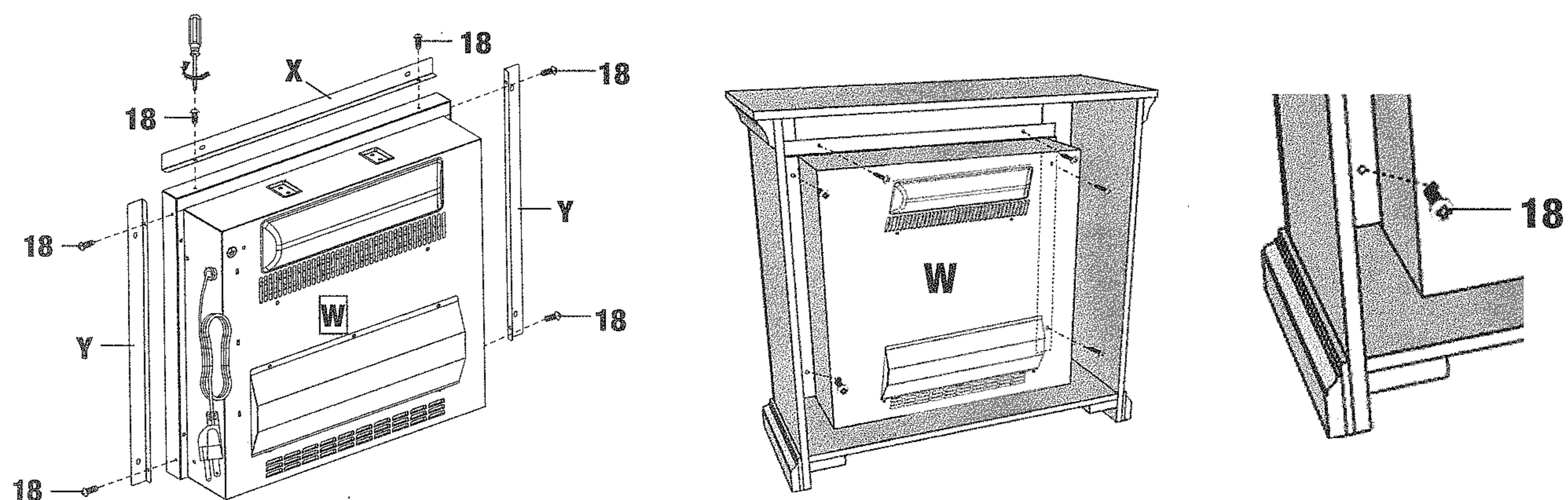
Установка каминной топки : осторожно установите каминную вставку (W) внутри камина и поставьте ее в соответствии с отверстиями. Будьте осторожны, чтобы не поцарапать обрамление. Проверьте, выровняйте, а затем прикрепите каминную топку (W) к каминной полке, вставив винты (18) через просверленные отверстия на планках (X и Y)
