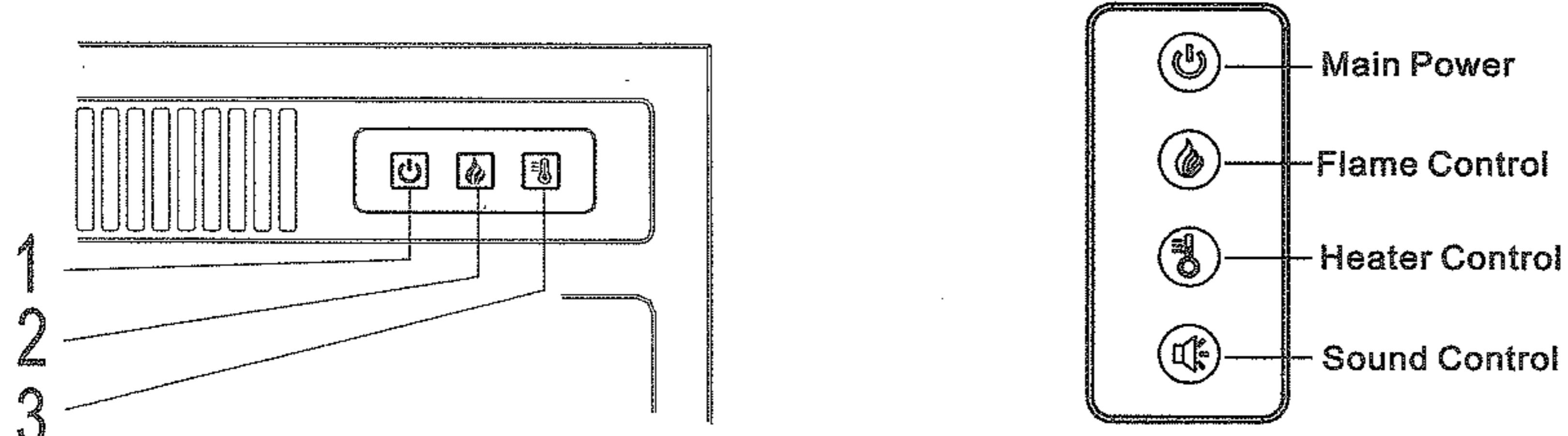
Панель управления электрокамином располагается в правом верхнем углу электрокамина. На панели управления расположены кнопки включения/выключения, контроля яркости пламени, включения/выключения нагревательного элемента.
